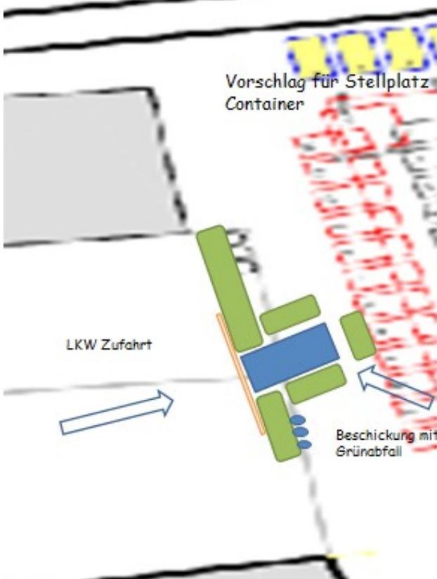
Vorschlag: Container (Maße L300xB185xH100; in der Zeichnung blau) in der bestehenden Hecke, die im mittleren Bereich auf Containerbreite weggenommen wird, unterbringen; zum Gräberfeld hin wird eine 3teilige Sichtschutz-hecke neu gepflanzt, mit 2 Lücken zur Beschickung mit Grünabfall; nach vorne zum Platz kommt ein Schiebetor, das den Blick auf den Container versperrt; der LKW muss so zukünftig nicht über den Friedhof insbesondere ein ehemaliges Gräberfeld
